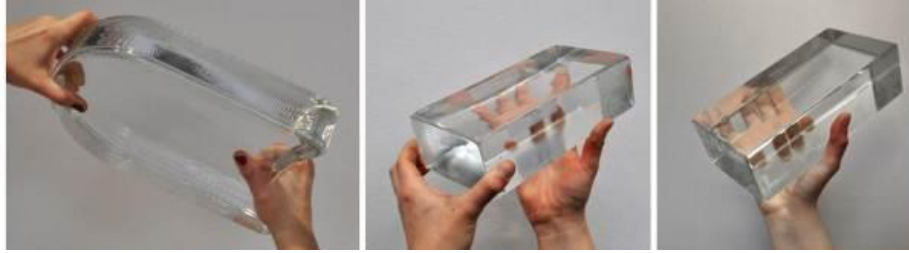
شكل رقم (19) يوضح الفرق بين بلاطة زجاج البوريسليكات والبلاطة من نوع زجاج الصودا جير
