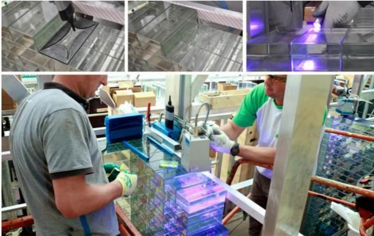
شكل (22) يوضح طريقة اللصق بين البلاطات وتعزيزها بالأشعة فوق البنفسجية
